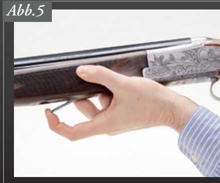
Den Vorderschaftriegel nach unten ziehen und dann das vordere Ende des Vorderschafts nach unten schwenken und von den Läufen wegziehen.
