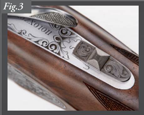
The thumb «safety» shown in the reaward «on safe» position.
