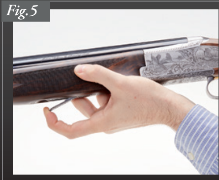
Tirez vers l'extérieur le système de verrouillage du garde-main, puis tournez l'avant du garde-main vers le bas, loin des canons
