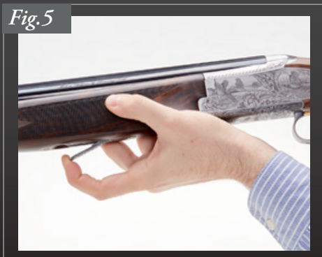
Tirar hacia fuera de la palanca del guardamanos, y a continuación girar la parte delantera del guardamanos hacia abajo retirándola de los cañones.
