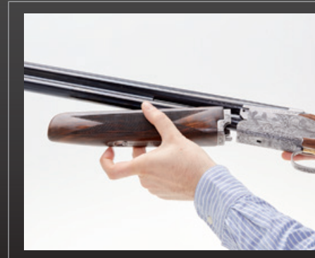
Tirez vers l'extérieur le système de verrouillage du garde-main, puis tournez l'avant du garde-main vers le bas, loin des canons
