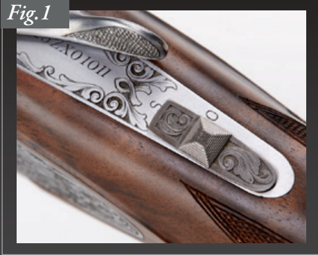
The thumb «safety» shown in the reaward «on safe» position.
