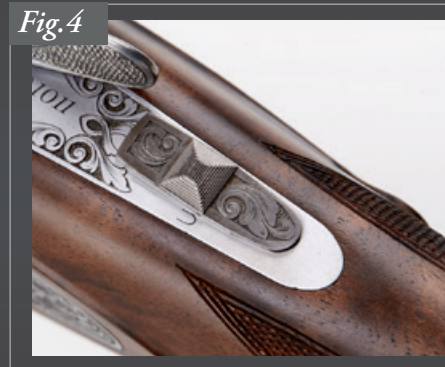
Sélecteur poussé vers l'avant en position «hors sécurité»
