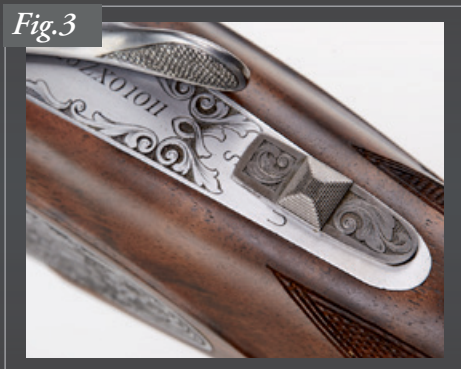
La palanca del "seguro" mostrada en la posición hacia atrás "seguro on" (activado).
