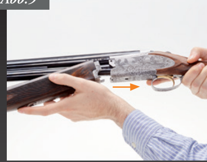
Den Stahlvorsprung auf der Rückseite des Vorderschaft-Metallteils in die gegenüberliegende Aussparung des Gehäuses schieben. Der Vorderschaft rastet hörbar am Lauf ein.
