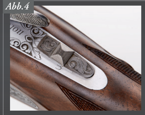
Sicherungsschieber in vorderer entsicherter Position.
