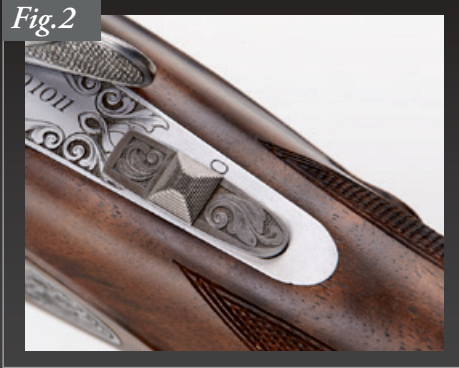
The thumb «safety» shown in the forward «off safe» position.
