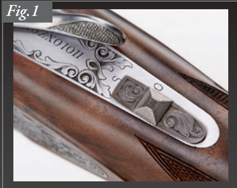
La palanca del "seguro" mostrada en la posición hacia atrás "seguro on" (activado).
