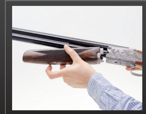
Den Vorderschaftriegel nach unten ziehen und dann das vordere Ende des Vorderschafts nach unten schwenken und von den Läufen wegziehen.
